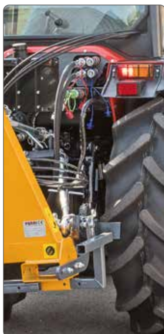
Impianto idraulico dipendente. Dependent hydraulic system.
