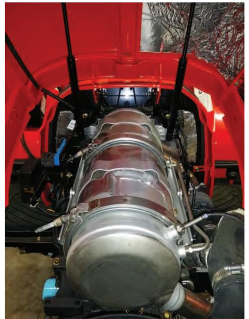
Außerdem verfügt er über einen Temperaturregler so wie 2 Drucksensoren die einen Differenzdruck vor und nach dem Rußfilter errechnen, womit der Verschmutzungsgrad des Filters erkannt wird.
